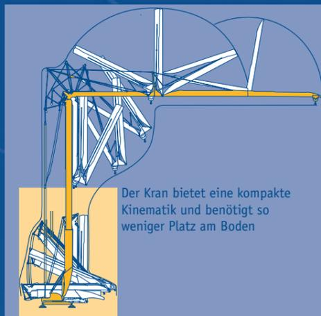
Der Kran bietet eine kompakte Kinematik und benötigt so weniger Platz am Boden
