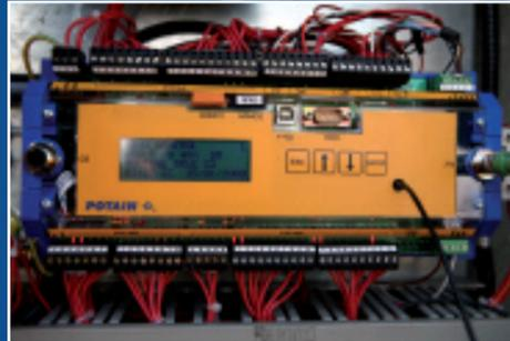
Im **Empfänger** der Funksteuerung befindet sich die Kommunikationstechnik der Maschine.
